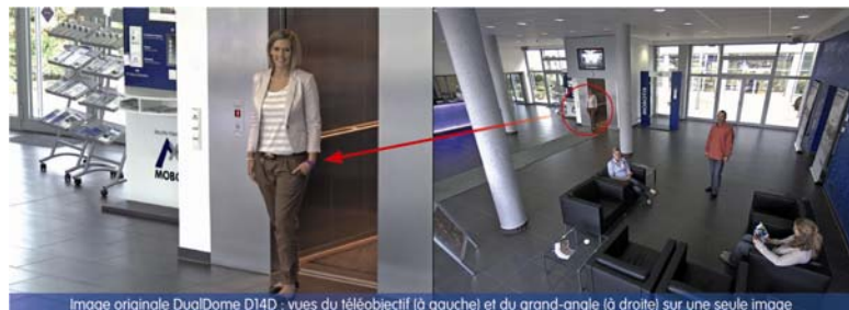
Image originale DualDome D14D - vues du téléobjectif (à gauche) et du grand-angle (à droite) sur une seule image
